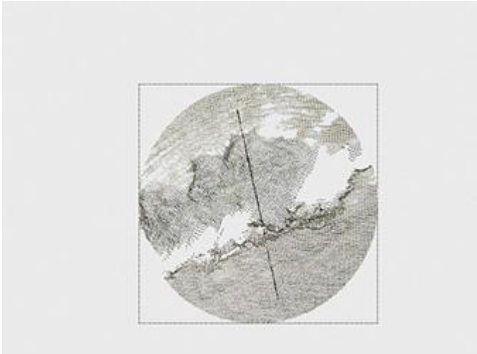
涡轮叶片裂纹的点云灰度图
