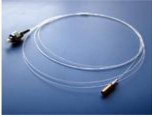
QX 研制的自聚焦透镜准直器可用于不同的波长，可以与 FC/PC 接头连接，QX 的自聚焦透镜准直器拥有 $\varnothing 1.8$  毫米的通光孔径并且可以耦合到标准的 62.5/200/400um 芯径尺寸的光纤中。
