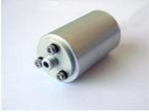
该产品设计精良,可连接到 FC/PC 或 SMA905 连接器末端,并装有 AR 膜层的非球面透镜。非球面透镜与 FC 连接器光纤之间的距离可调,从而补偿焦距变化,准直某一特定波长在特定距离下的光束。
